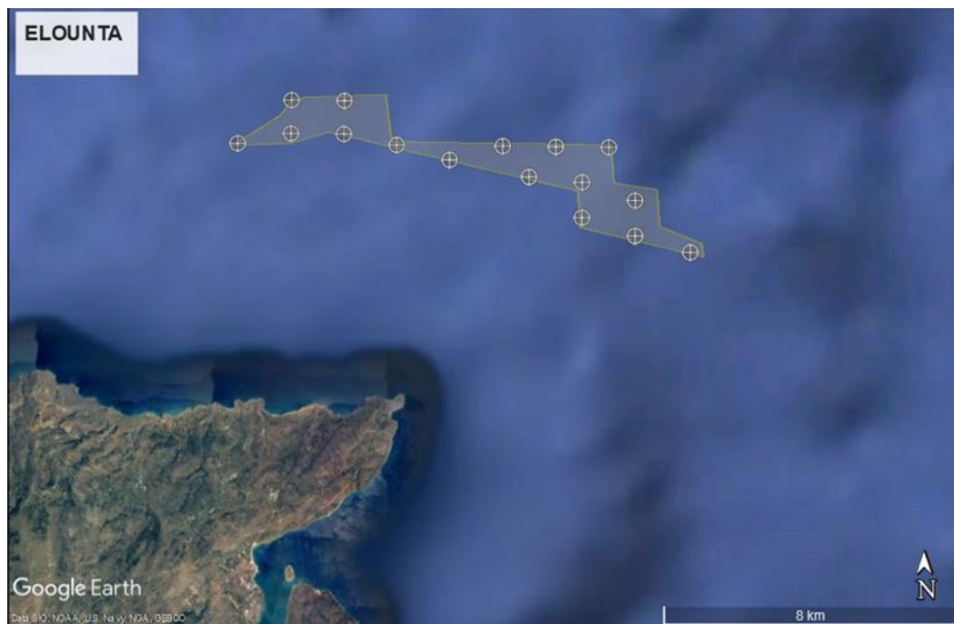
Figure D.11: Vestas V164 – 8 MW, 6X9 RD layout (16x8) 128 MW
